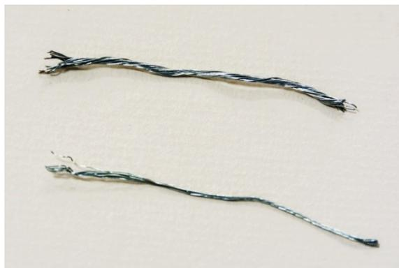
Figure 3 Exemple de Fil Tressé et Torsadé
